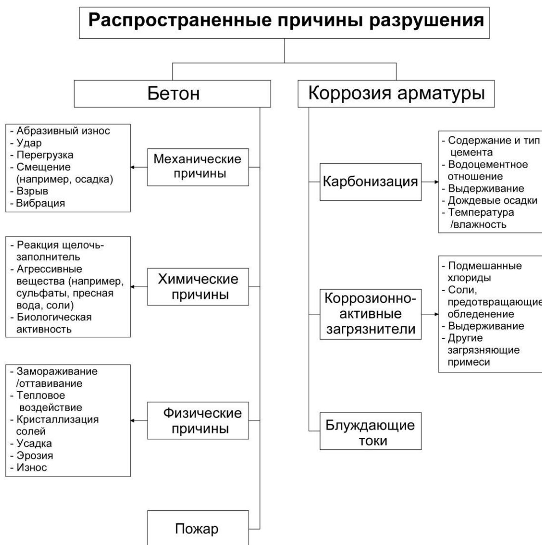
Рисунок 2.2 - Распространенные причины разрушений конструкций
