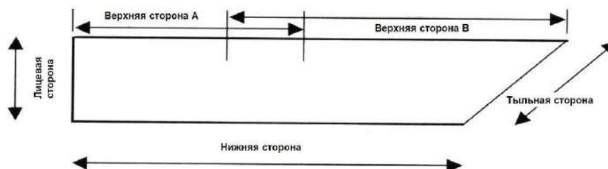
Рисунок 4 - Обозначения сторон стяжной сетки
