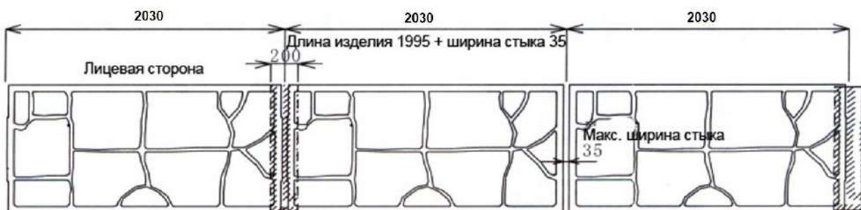
Рисунок 27 - Варианты регулировки длины шириной стыков.
