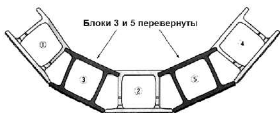
Рисунок 29 (с) - Пример выполнения выгнутой кривой ( R=5 м)
