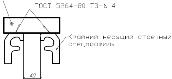
Рис.5. Конструкция деформационного шва ОП ДШ 50/80/100, связанная скобой, подготовленная к поставке
