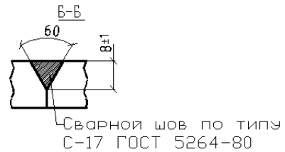
Рис.8. Монтажный стык деформационного шва ОП ДШ(краиний несущий уголкоый спецпрофиль)
