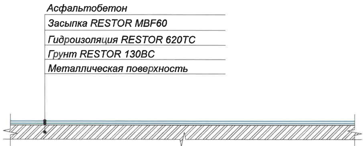
Рисунок 9 - Состав гидроизоляционной системы «RESTOR.TOP» для металлического основания.
