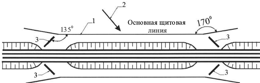
Рисунок 5 - Ограждение мест перехода из выемки в насыпь:
