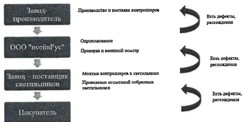
Рисунок 2 - Технологический процесс монтажа интеллектуального контроллера в светильник
