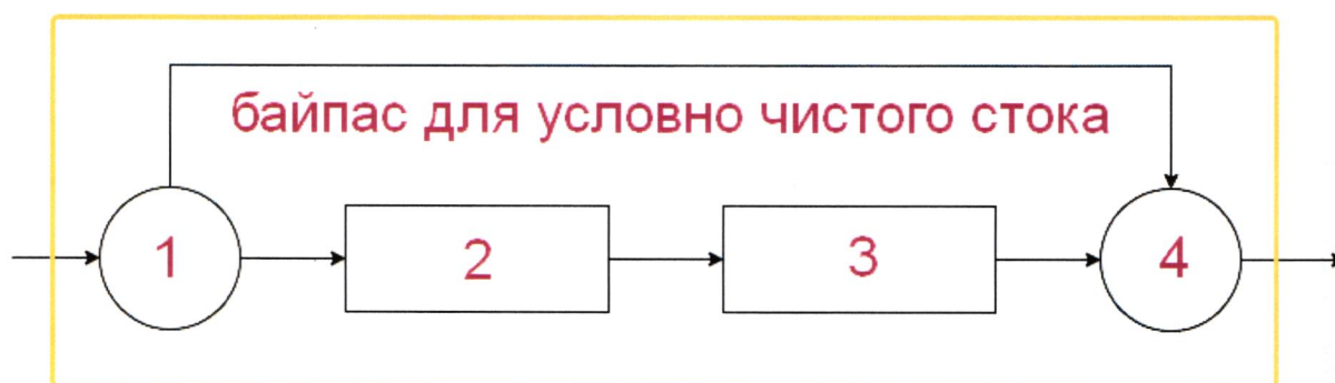
Рисунок 4.1 – Условная схема очистки поверхностных стоков
