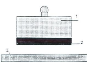
Рисунок Б.1 - Отрыв по контактному слою (Адгезия)
