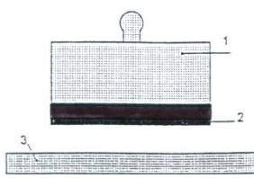
Рисунок Д.1 - Отрыв по контактному слою (Адгезия)
