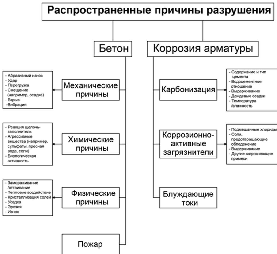
Рисунок 2 – Распространенные причины разрушений конструкций
