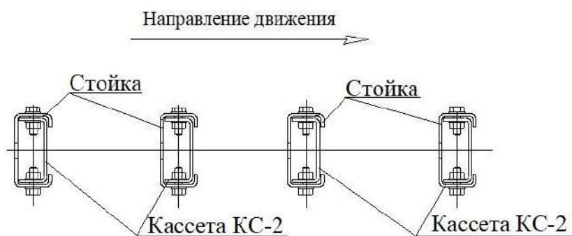
Рисунок А.22 – Схема расположения стоек четырех тросового одностороннего ограждения
