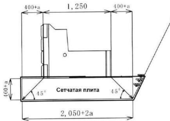
Рисунок 6 - Схема устройства габионно-сетчатой плиты (матрац Рено).
