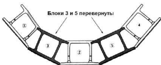
Рисунок 29 (с) - Пример выполнения выгнутой кривой ( R=5 м)
