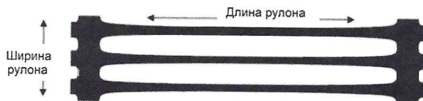
Рисунок 1 – Общая схема георешетки Tensar серии RE500
