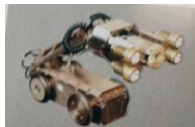
Рисунок 22. Общий вид телевизионных и телеинспекционных систем DIGIMAX
