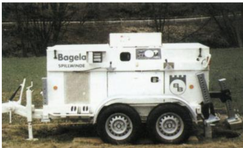
Рисунок 9 Общий вид электрической лебедки BAGELA
