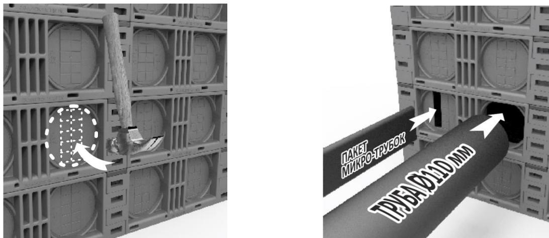
Рисунок 31 – Подготовка отверстий в смотровом устройстве и ввод кабельных каналов
