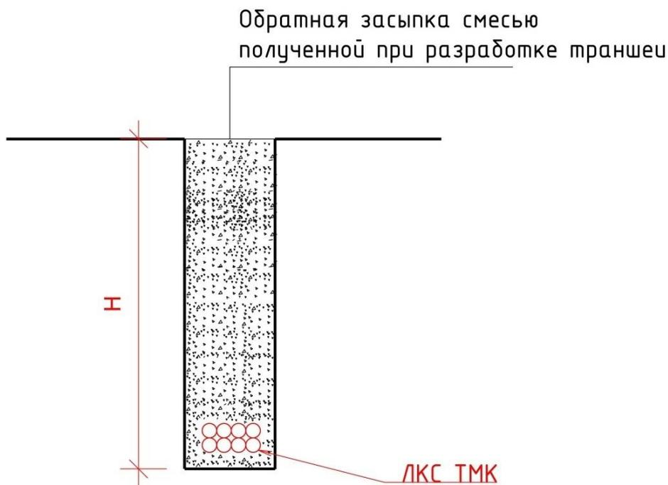
Рисунок 13 – Пример типового восстановления минитраншеи в неукрепленной части обочины
