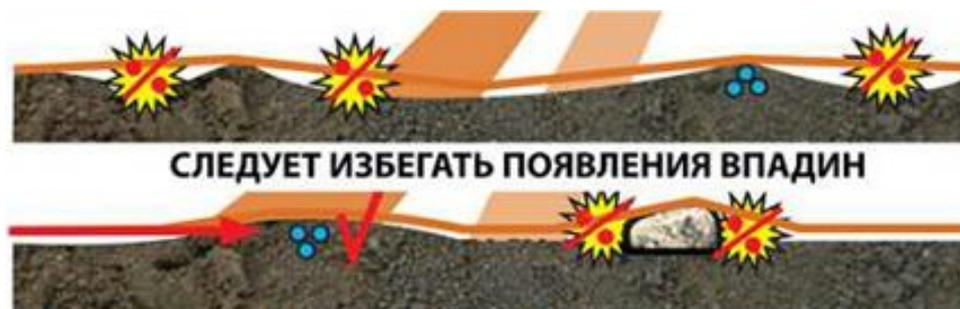
Рисунок 9 – Причины, усложняющие пневматическую задувку кабеля
