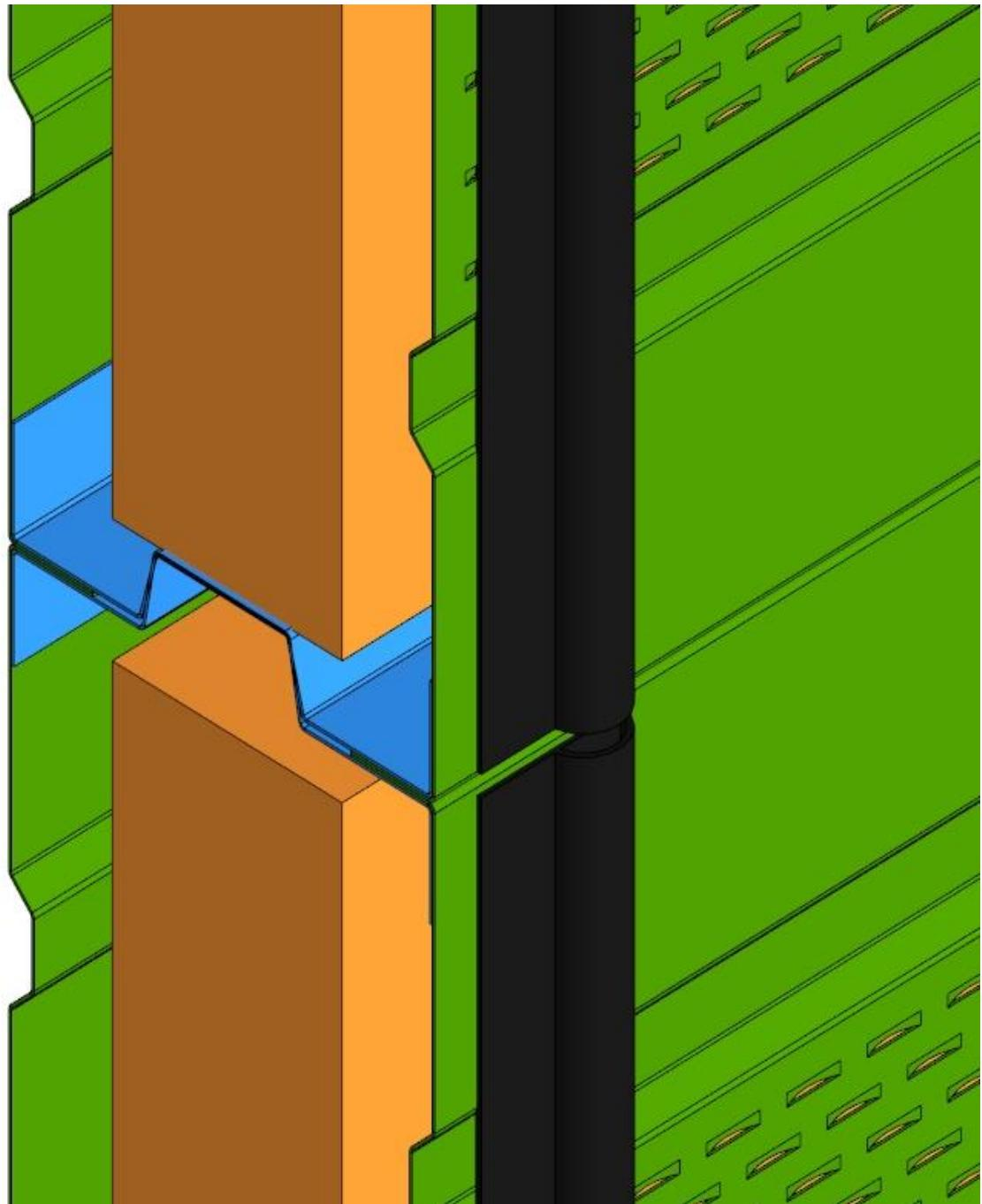
**Рисунок В.1 - Конструкция соединения шумозащитных панелей.
