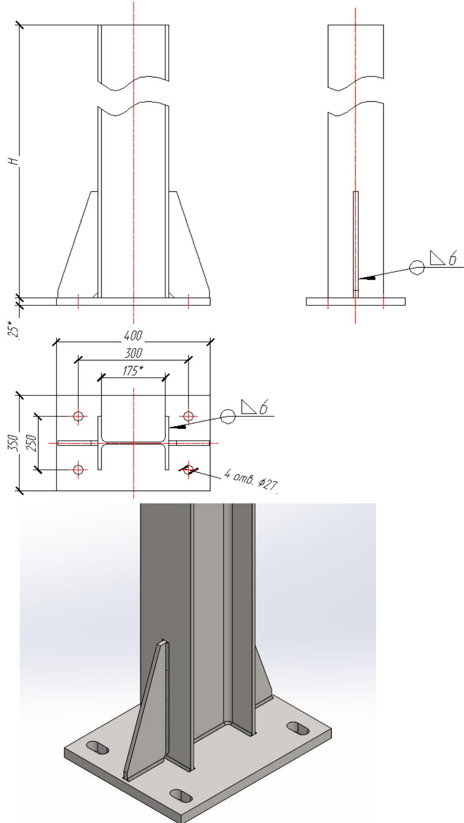
Рисунок Г.1 - Конструкция стойки щумозащитного экрана.
