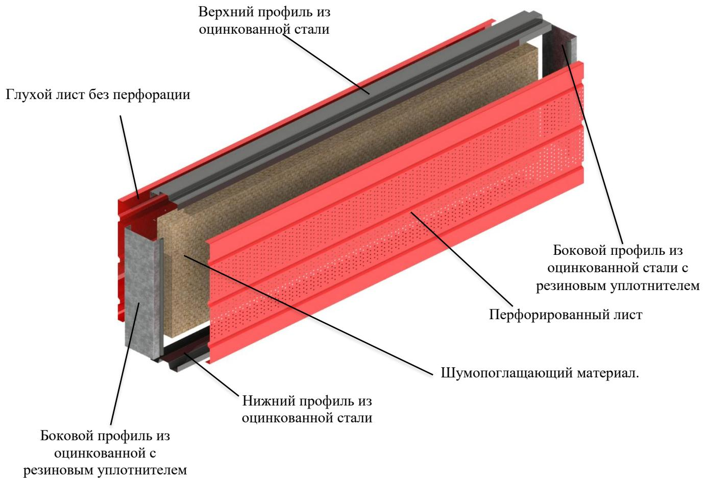
Рисунок А.1- Конструкция шумозащитной панели.
