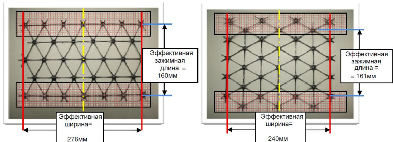
а) образцы, вырезанные вдоль полотна ( $0^\circ$ ) и под углом  $60^\circ$ ;
