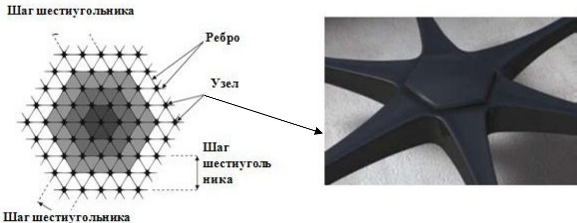
Рисунок 1 - Схематическое изображение георешетки и ее узел
