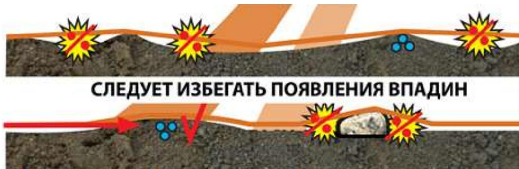
Рис. 4.1.2 Причины усложняющие пневматическую прокладку кабеля
