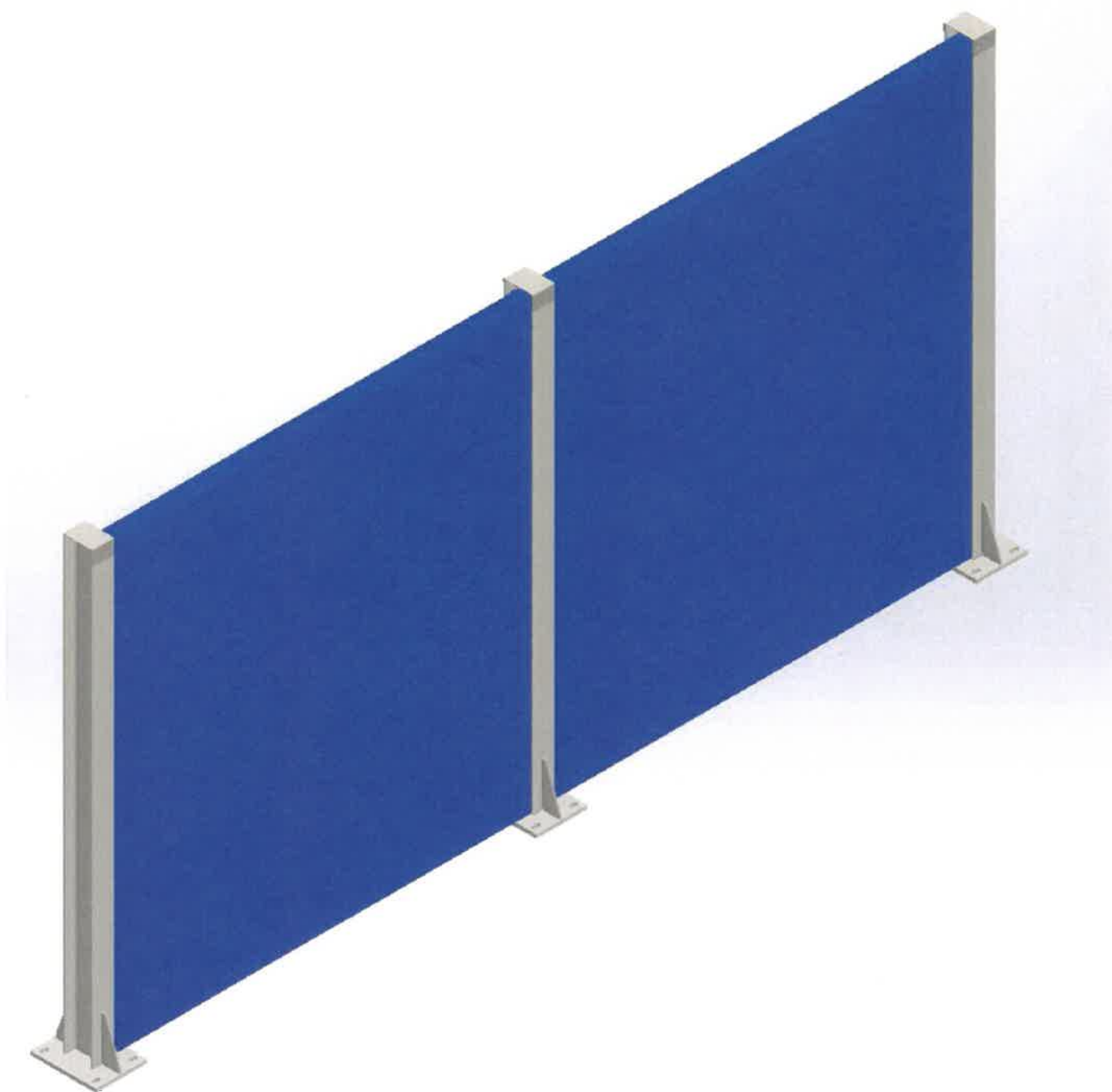
Рисунок Д.1 - Конструкция установки шумозащитной панели в стойки.
