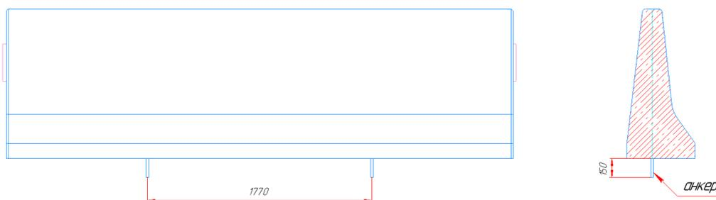
Рис.2. Дополнительная анкеровка блоков мостового класса на примере одностороннего блока
