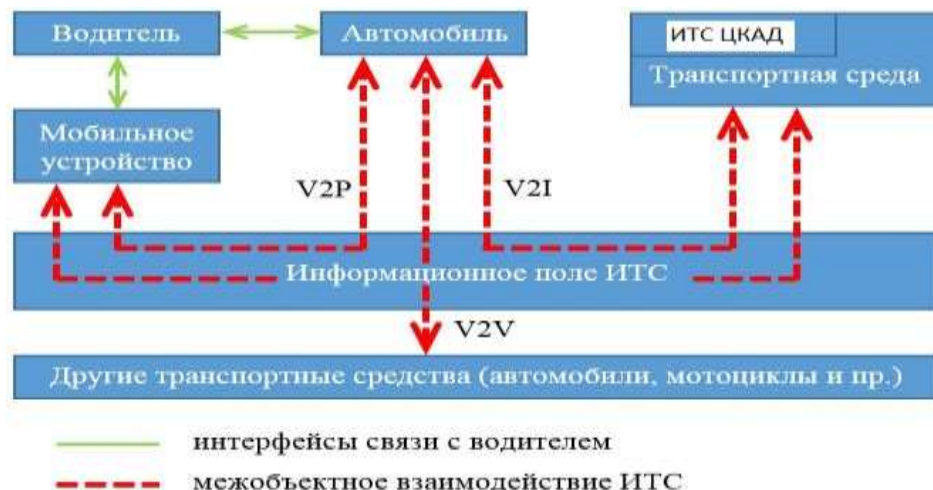
Рис.2.4. Функциональная схема кооперативной ИТС.
