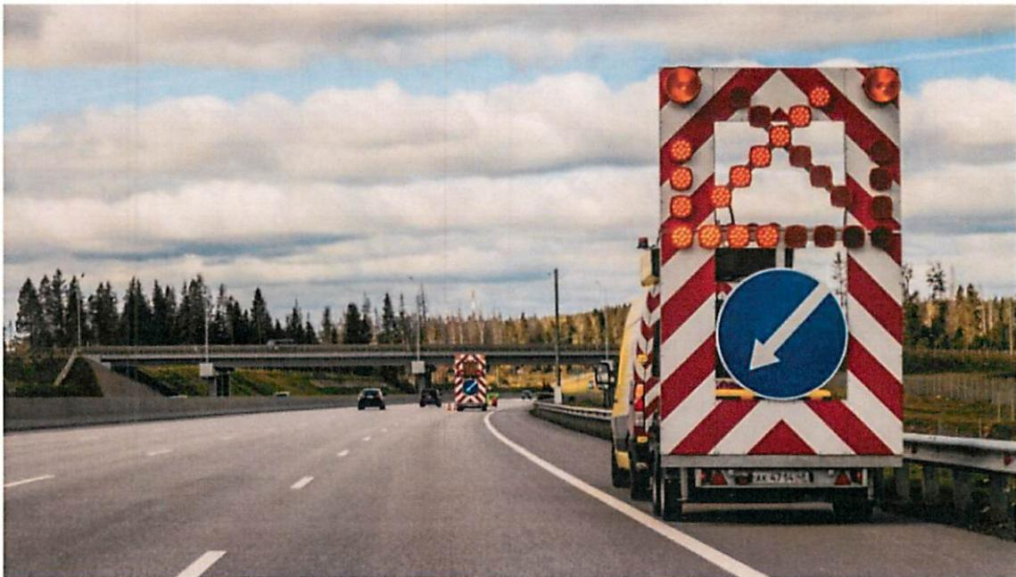
Рисунок 3 – СТС САК в сцепке с комплексом мобильным
