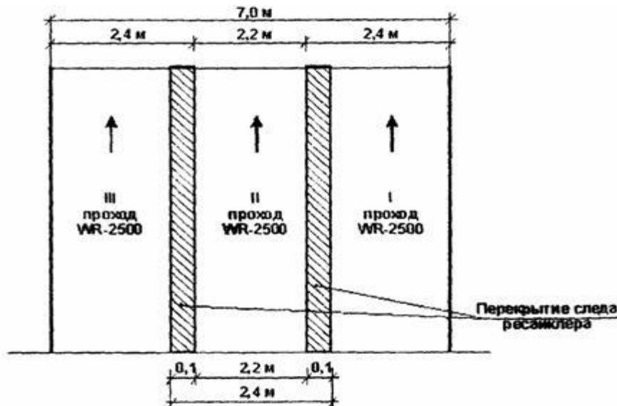
Рисунок. 2 - Схема работы ресайклера WR 2500
