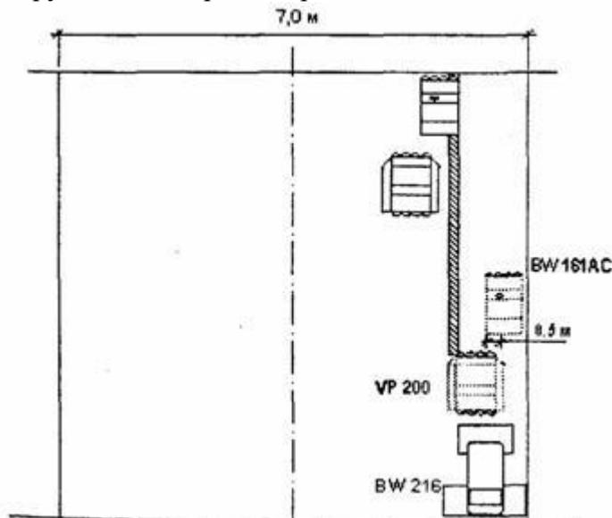
Рисунок 3. - Схема уплотнения основания катками
