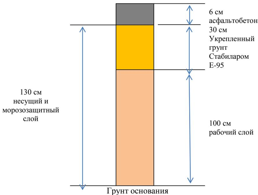
Рисунок 1 Конструкция дорожной одежды
