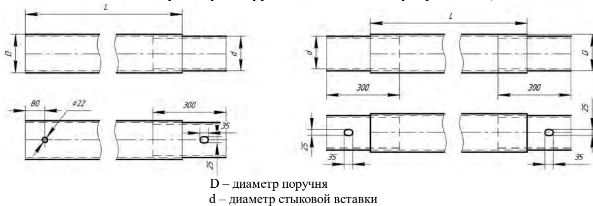
Г.12 Основные параметры поручней показаны на рисунке Г.13, Г.14 и Г.15
