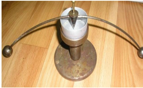
Рисунок Г.6 - Конус Васильева для определения влажности на границе текучести
