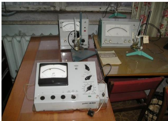
Рисунок Г.8 - рН-метр для определения рН водной вытяжки грунта и водного раствора стабилизатора
