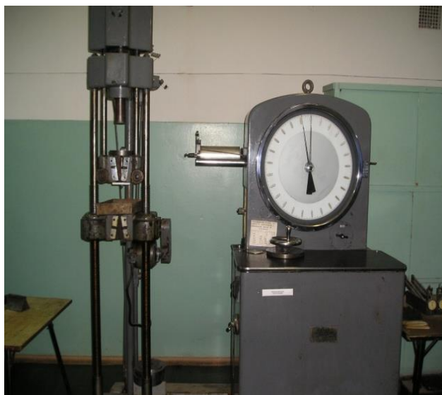
Рисунок Г.10 - Разрушающая машина для определения прочностных показателей стабилизированных, комплексно-стабилизированных и комплексно-укрепленных грунтов
