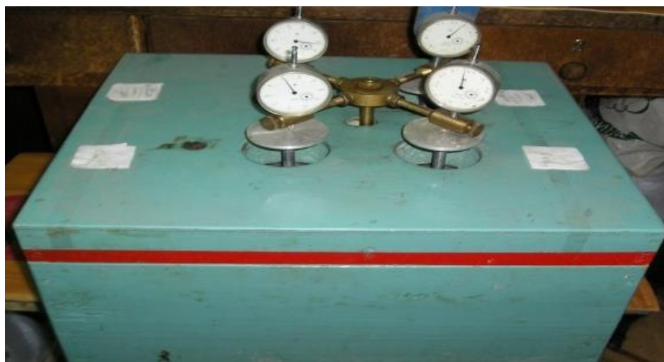
Рисунок Г.11 - Установка для определения степени пучинистости грунтов
